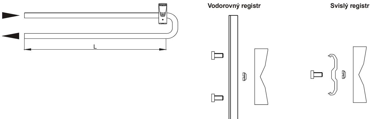
Registry z ocelových trubek se používají v prostorech s nízkými hygienickými a estetickými nároky na otopná tělesa. Rozměry se volí dle potřeby. Registry se vyrábějí zpravidla podle výkresů přiložených k projektu. Montážní materiál možno použít pro trubky od ø 30 do ø 110 mm.
