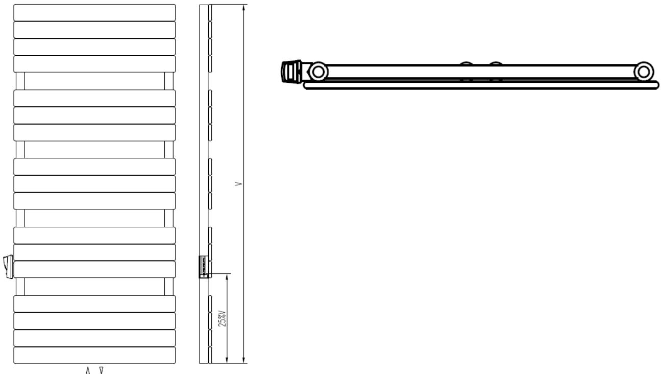
Základní rozměry otopného tělesa Viktor a údaje pro správnou montáž indikátoru (mm):
