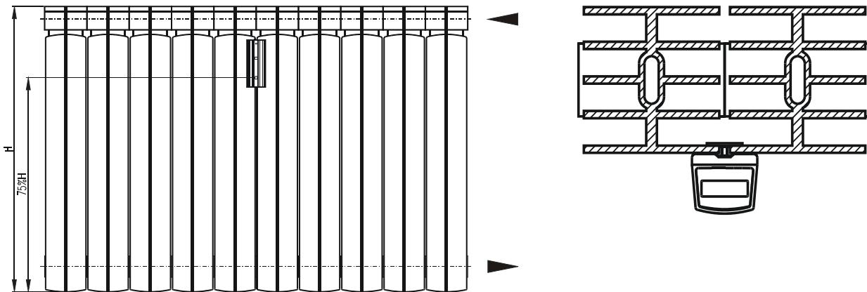
Základní rozměry otopného tělesa SOLAR 500 a údaje pro správnou montáž indikátoru (mm):
