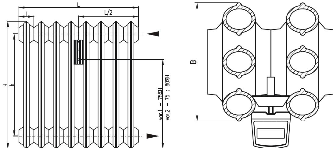
Základní rozměry otopného tělesa KALOR – 500x110 při 10-ti článkové sestavě a údaje pro správnou montáž indikátoru (mm):
