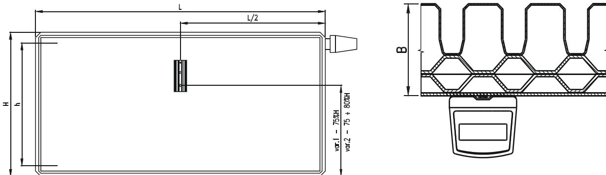
Základní rozměry otopného tělesa RADIK, provedení VENTIL KOMPAKT, typ 11 PLAN VK a údaje pro správnou montáž indikátoru (mm):
