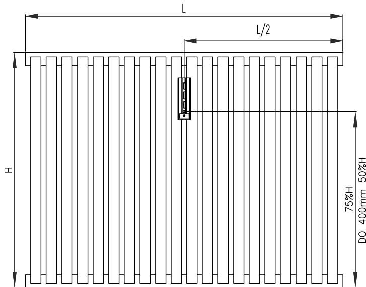
Základní rozměry otopného tělesa typ Nemo 530/915 údaje pro správnou montáž indikátoru (mm):
