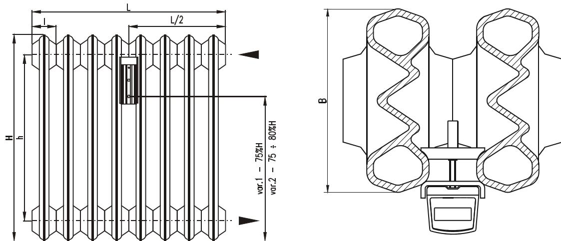
Základní rozměry otopného tělesa S-130 při 10-ti článkové sestavě a údaje pro správnou montáž indikátoru (mm):
