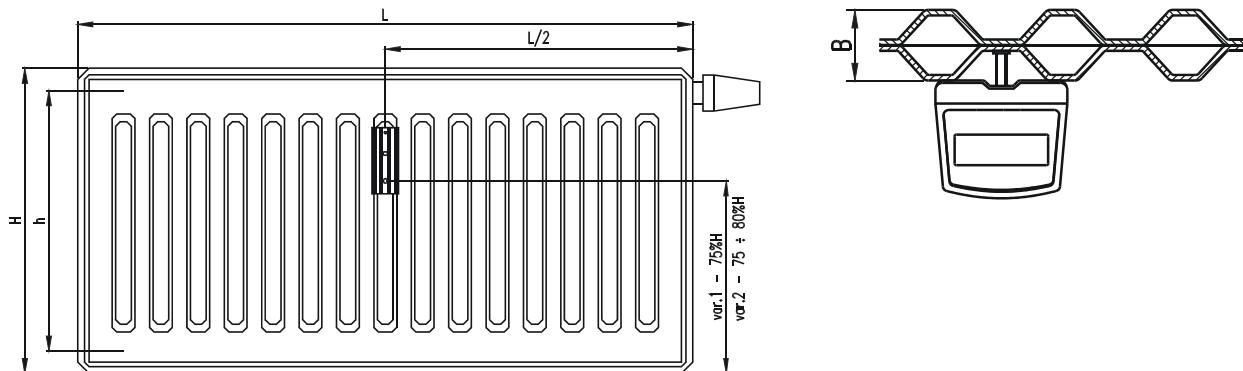
Základní rozměry otopného tělesa RADIK, provedení KLASIK, typ 10 a údaje pro správnou montáž indikátoru (mm):
