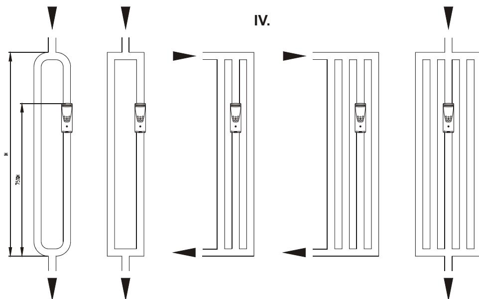
Ilustrace 13: Ilustrace 7: Umístění E-ITN 30 při instalaci na svislá trubková otopná tělesa
