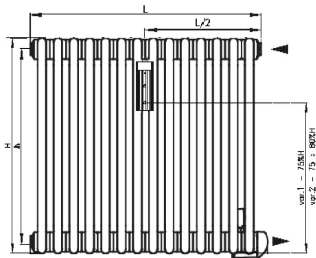
Základní rozměry otopného tělesa typ Charleston 210/592 při 4-článkové sestavě a údaje pro správnou montáž indikátoru (mm):
