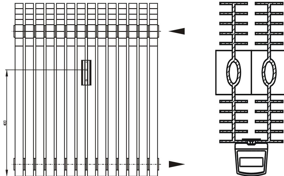
Základní rozměry otopného tělesa FONAL TYP A 650-175 a údaje pro správnou montáž indikátoru (mm):
