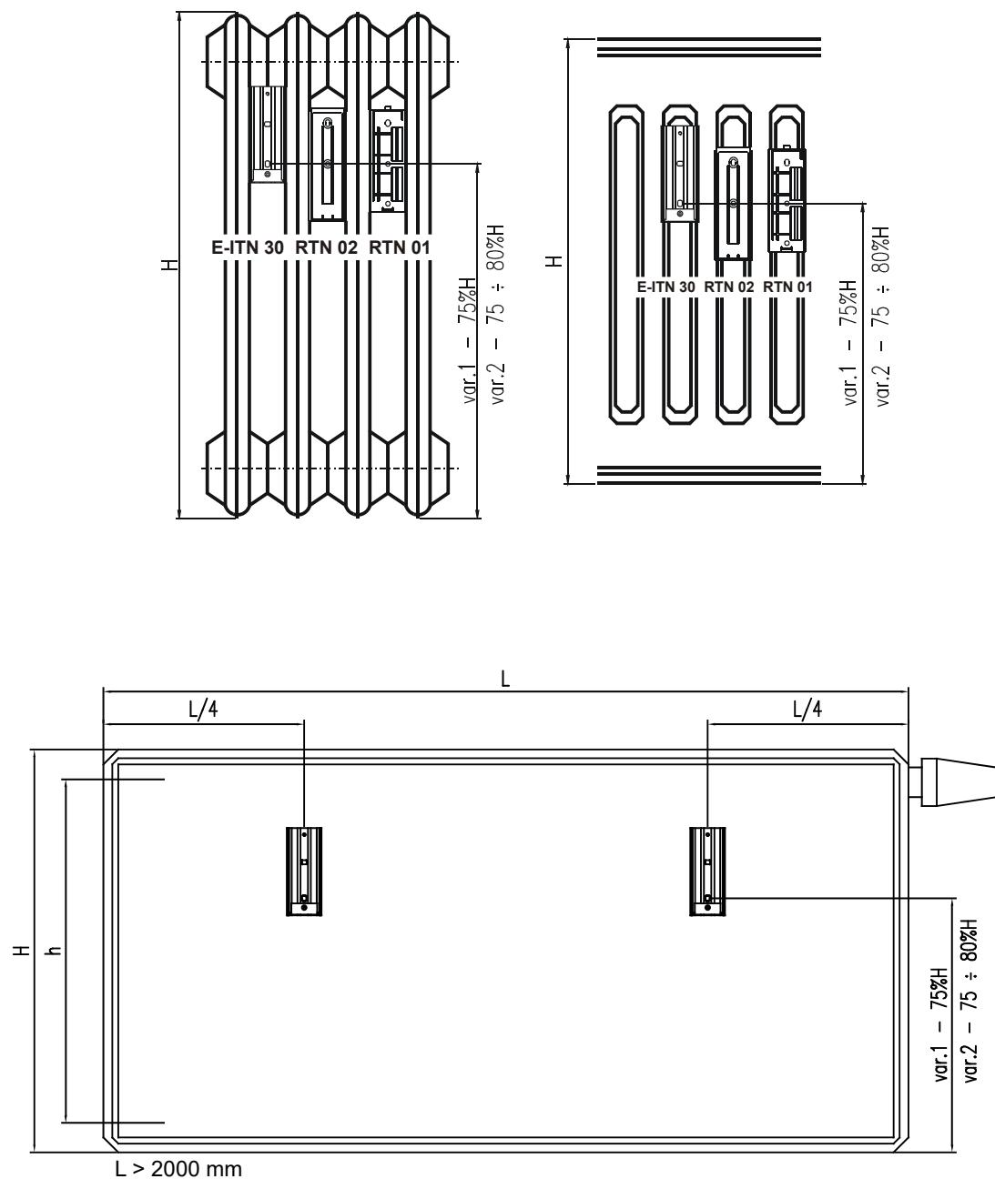
Ilustrace 7: Vertikální a horizontální umístění E-ITN 30
