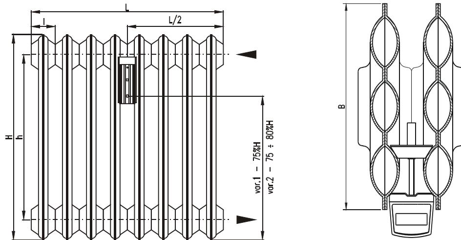
Základní rozměry otopného tělesa typ NERIA 500/150 při 10-ti článkové sestavě a údaje pro správnou montáž indikátoru (mm):
