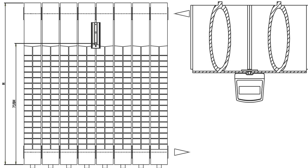
Základní rozměry otopného tělesa KORAL a údaje pro správnou montáž indikátoru (mm):
