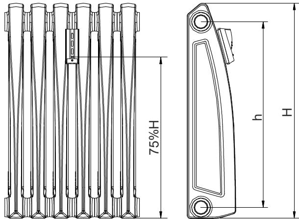
Základní rozměry otopného tělesa typ Nemo 530/915 údaje pro správnou montáž indikátoru (mm):
