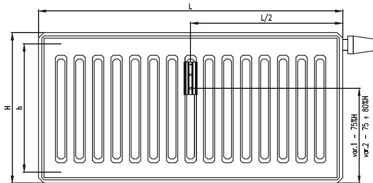
Základní rozměry otopného tělesa typ Nemo 530/915 údaje pro správnou montáž indikátoru (mm):
