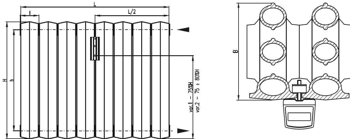
Základní rozměry otopného tělesa KALOR 3 při 10-ti článkové sestavě a údaje pro správnou montáž indikátoru (mm):
