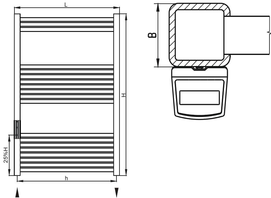
Základní rozměry otopného tělesa K 750/1640 a údaje pro správnou montáž indikátoru (mm):
