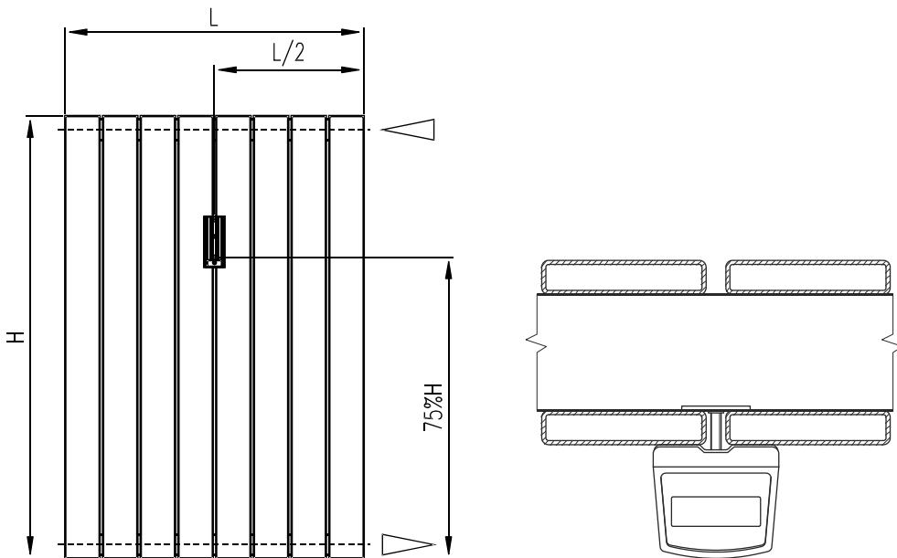
Základní rozměry otopného tělesa Koratherm a údaje pro správnou montáž indikátoru (mm):
