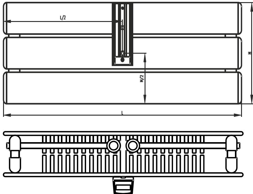
Základní rozměry otopného tělesa KORATHERM horizontal K22HM a údaje pro správnou montáž indikátoru (mm):
