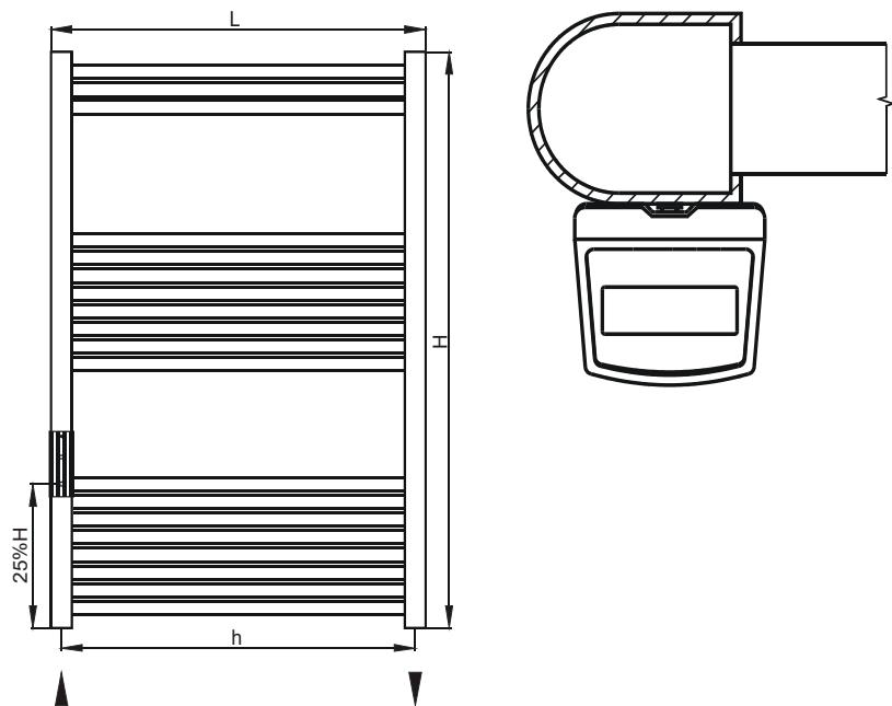
Základní rozměry otopného tělesa K 750/1640 a údaje pro správnou montáž indikátoru (mm):
