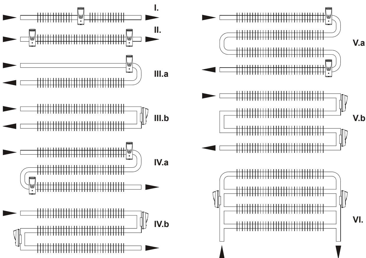
Ilustrace 11: Umístění E-ITN 30 při instalaci na vodorovná trubková otopená tělesa
