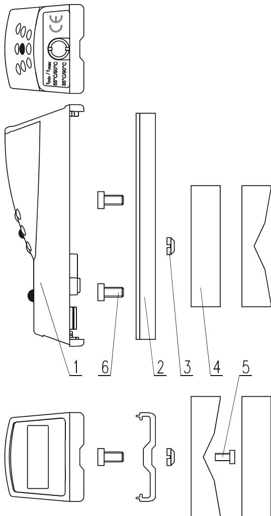
Ilustrace 10: Montážní materiál pro instalaci
