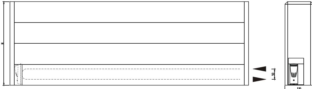
Základní rozměry otopného tělesa TEMF.040/110/10 a údaje pro správnou montáž indikátoru (mm):
