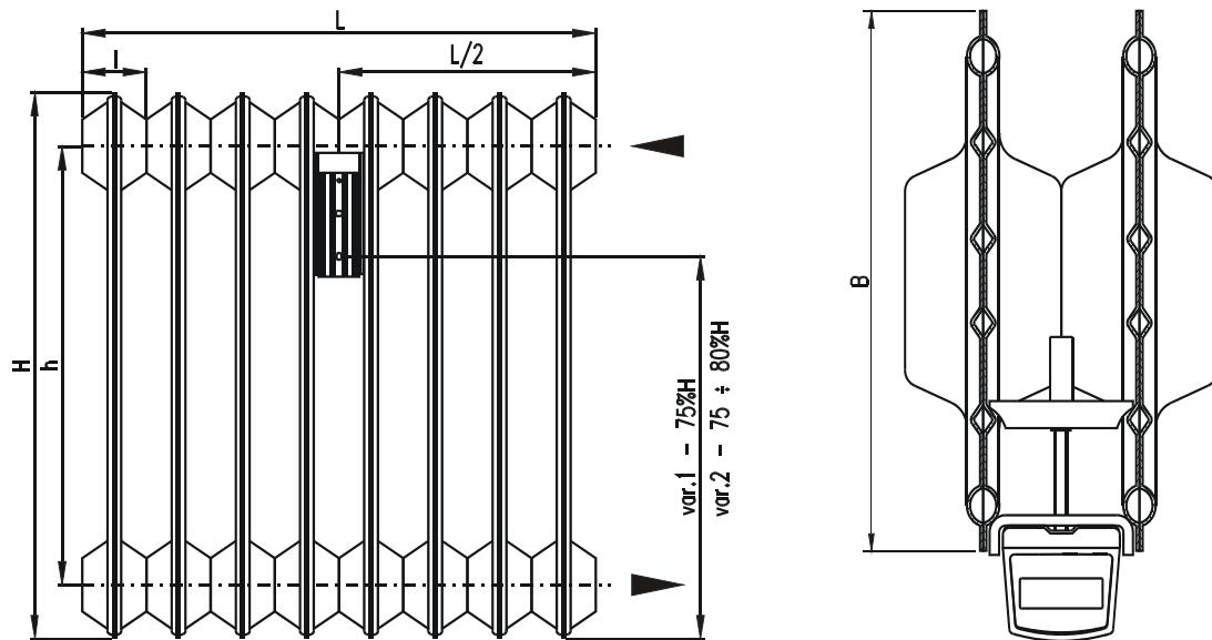
Základní rozměry otopného tělesa typ SVRATOUGH 500/160 při 10-ti článkové sestavě a údaje pro správnou montáž indikátoru (mm):
